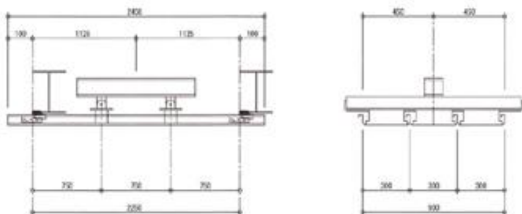
図-3 正荷重時の曲げ耐力試験方法
