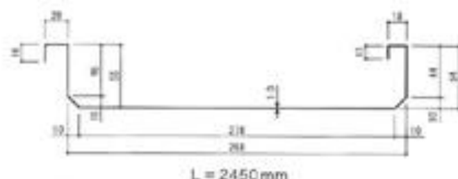
図-1 ハーバーストロングルーフ断面形状
